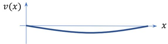
La fonction donnant la déformée  $v(x)$  sera donc du type convexe (courbure similaire à la fonction  $x^2$ ). Rappel : la déformée d'une poutre représente, en fonction de  $x$ , l'écart à la position de la ligne neutre de la poutre sans charge.
