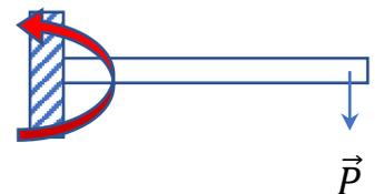
L'encastrement transmet à la poutre en A un moment  $\vec{\Gamma}_A$  qui est un couple pur :  $\vec{\Gamma}_A = \Gamma_A \vec{z}$  avec une constante positive  $\Gamma_A$ . Lorsque l'on écrira la relation  $\sum \vec{M}_{\vec{F}_{ext}/A} + \sum \vec{C}_{ext} = \vec{0}$ , on obtiendra alors :  $\vec{AC} \wedge \vec{R}_A + \vec{CB} \wedge \vec{P} + \vec{\Gamma}_A = \vec{0}$ . Il restera à bien choisir le point C.
