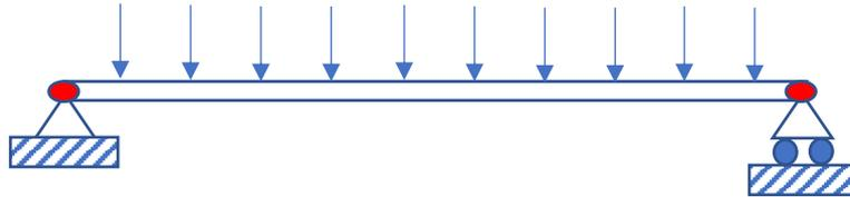
Une poutre est en appui double à gauche (deux directions sont bloquées) et en appui simple à droite (une seule direction bloquée), elle supporte une charge linéique noté  $q$ .
